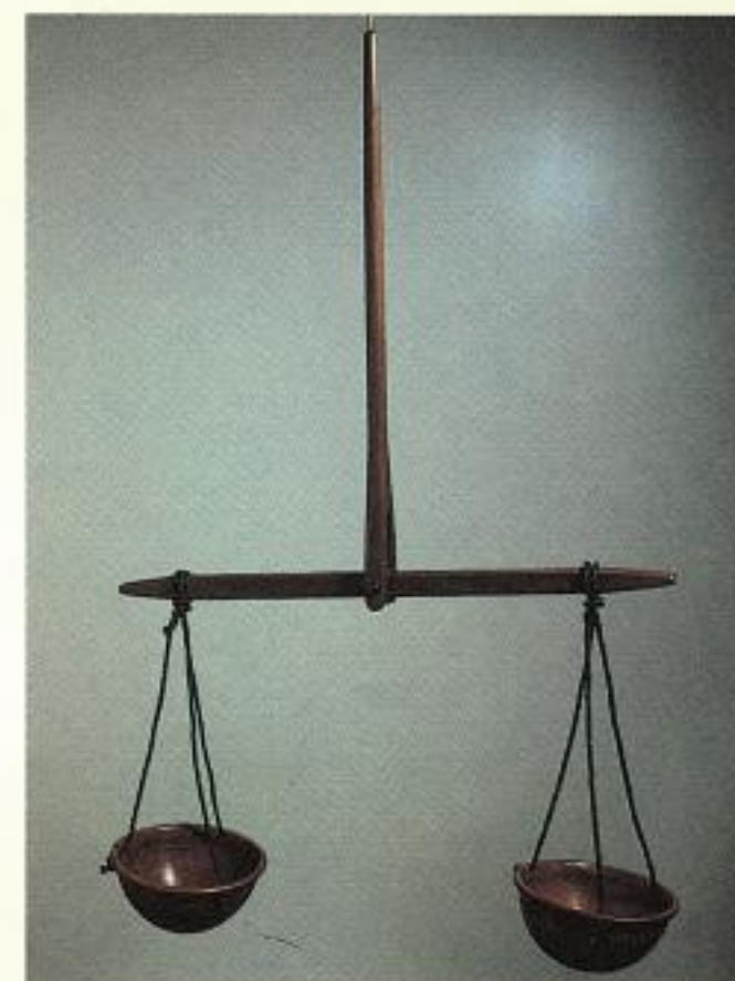
Modello e disegno di bilancia a bracci uguali, giogo e forbice in legno di noce, indice incorporato, corde legate all'estremit  del giogo, piatti in legno di pino a ciotola raccolta, mm. 450x522, 1991
